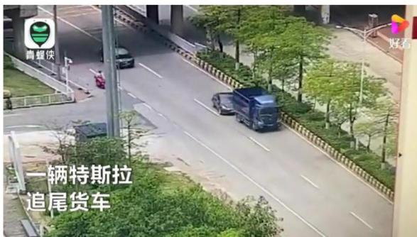
一、前方有隧道？虽然图片中的桥下阴影带不大，但若 T 查觉到前方视野较昏暗，即开启大灯（但，外侧车道之车辆并未开启灯光）。值得一提，T 由上游观察前方图象时，大货车较小型车高大，会遮蔽比较多的光线，图象更为昏暗（加以大货车为深蓝色且尾灯未亮），可能被 T 辨识为“前方有隧道”，而开启大灯。
