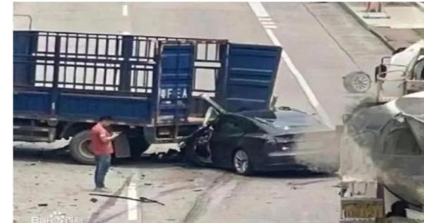
照片說明：T通過減速標線，於進入橋下陰影區時，似有開啟大燈；T於追撞大貨車前，車體方向是斜向其右前方。碰撞處的上游沒有煞車痕，痕跡終止於T車輛下方，其型態扭曲交疊、寬細不一，T左前方嵌入大貨車右下方，兩車停止時，其車頭朝向左前方，跨越二車道。
